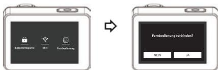
2. Folgen Sie den Anweisungen und halten Sie beide abgebildeten Knöpfe zeitgleich gedrückt. So verbinden Sie die Fernbedienung mit der Kamera.
